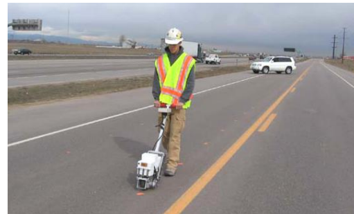
FIGURA 4: Inclinómetro utilizado para Medir el Perfil de una Carretera
